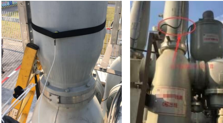
现场超声波测试照片及异常位置示意图
